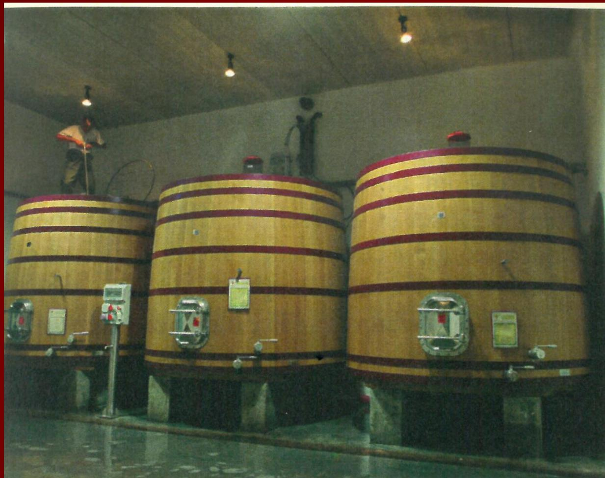
*Cuverie bois, équipée de 6 cuves en chêne, d'une capacité de 85 hl.
