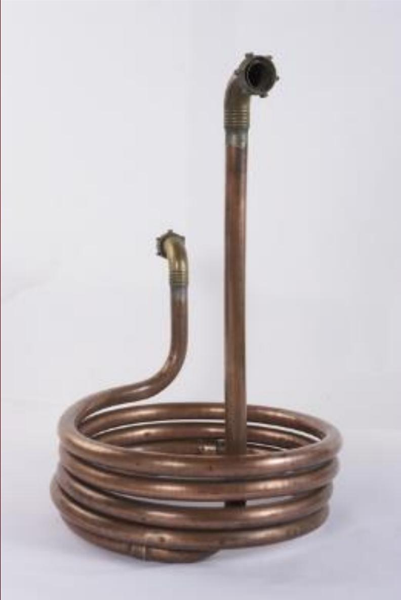
*Le serpentin en cuivre permettait autrefois de refroidir le moût pendant la fermentation alcoolique.*
