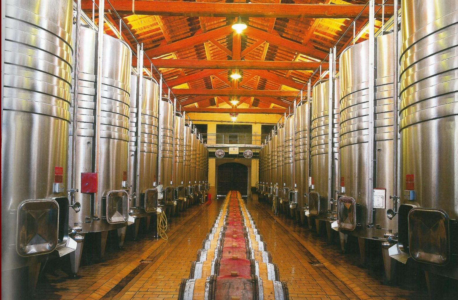
*Cuverie du Domaine de Beurenard : 24 cuves inox thermorégulées d'une capacité de 150 hl. Ce confortable potentiel de stockage permet, des fermentations longues, de 3 semaines, et rentrer toute la récolte, sans être obligé de décuver.*
